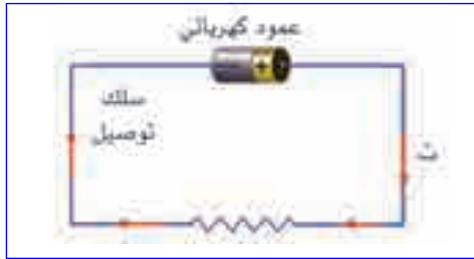
شكل (٦): دائرة كهربائية مغلقة
