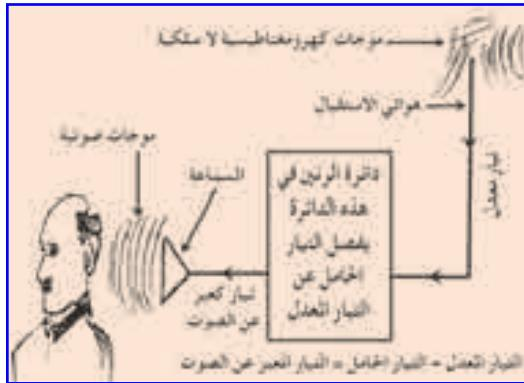
شكل (١٩) إستقبال الأصوات بواسطة جهاز المذيع (الراديو)
