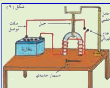
شكل (٧) تركيب المغناطيس الكهربائي
