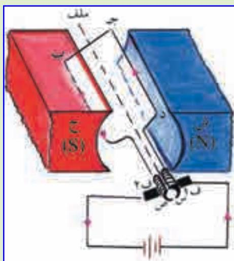
شكل (١٥) تركيب المحرك الكهربائي (المotor)
