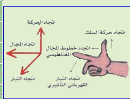
شكل (١١) تحديد اتجاه التيار التأثيري
