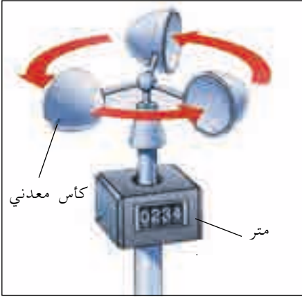
الشكل ( ٢ ) الأنيمو متر لقياس سرعة الرياح
