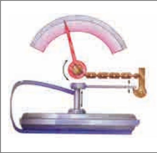
شكل ( ٨ ) الباروجراف جهاز قياس الضغط الجوي
