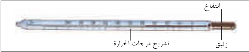
شكل ( ١ ) التيرموميتر الزئبقي
